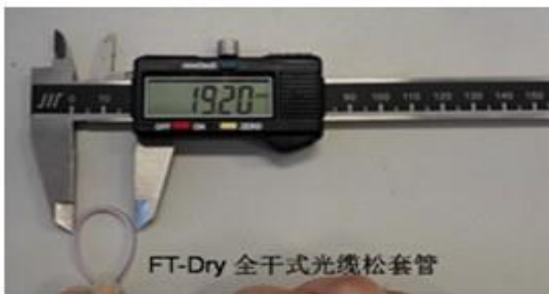
新型干式套管的弯折情况
