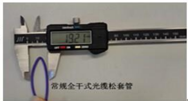
常规干式套管的弯折情况
