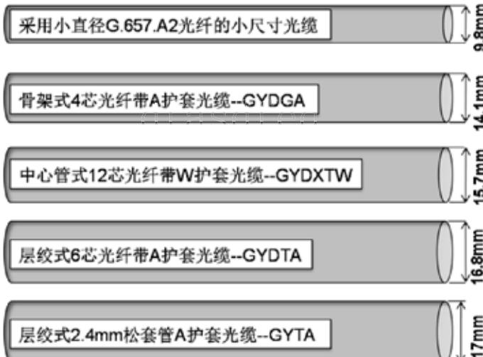
图 3. 不同结构管道敷设光缆的直径对比
