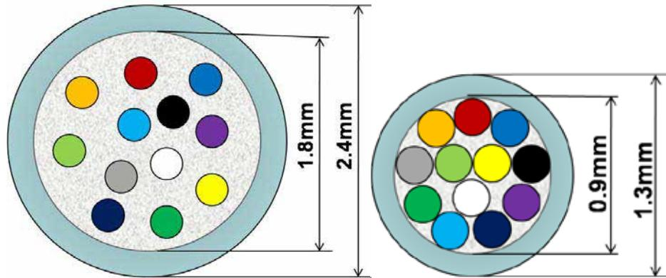
2.4mm 光纤松套管内含 12 芯  $250 \mu\text{m}$  G.652 光纤
