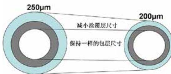
图 1 光纤外径尺寸减小的示意图
